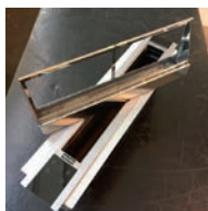
Vyjímatelný nerezový kolektor na tekutinu
